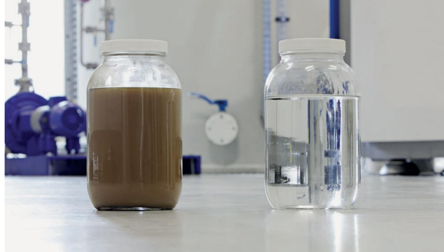
Das untenstehende Rechenbeispiel verdeutlicht die Kosteneffizienz unserer VACUDEST Vakuumdestillationssysteme im Vergleich zur Abwasserentsorgung. Bei diesem Referenzkunden fällt jährlich eine Abwassermenge von 3.000 m<sup>3</sup> als verbrauchte Kühlschmierstoffemulsionen an. Er bereitet dieses Abwasser auf, statt es zu entsorgen und leistet damit einen wertvollen Beitrag zu mehr Wirtschaftlichkeit und mehr Nachhaltigkeit.
